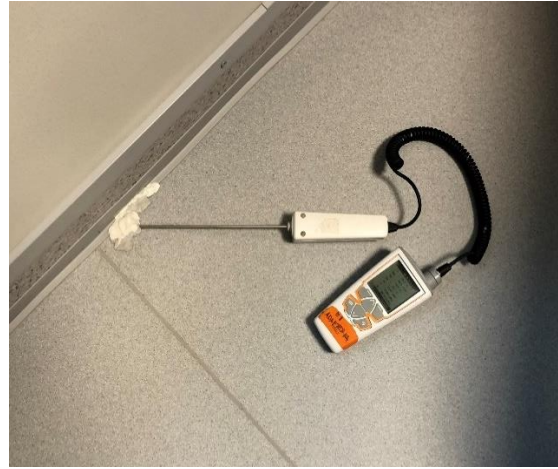
Kuva 2 Viiltomittaus Kielojen tilassa 1.20
