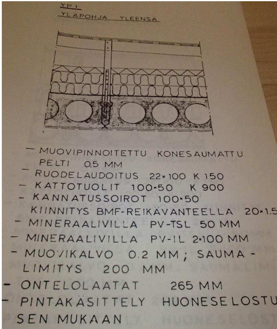
Kuva 7. Liikuntasalin yläpohja- ja vesikattorakenteet.
