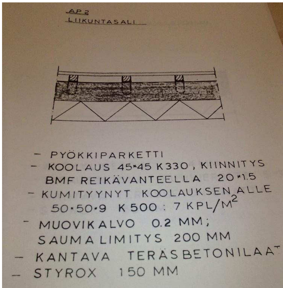
Kuva 6. Liikuntasalin alapohjarakenteet.
