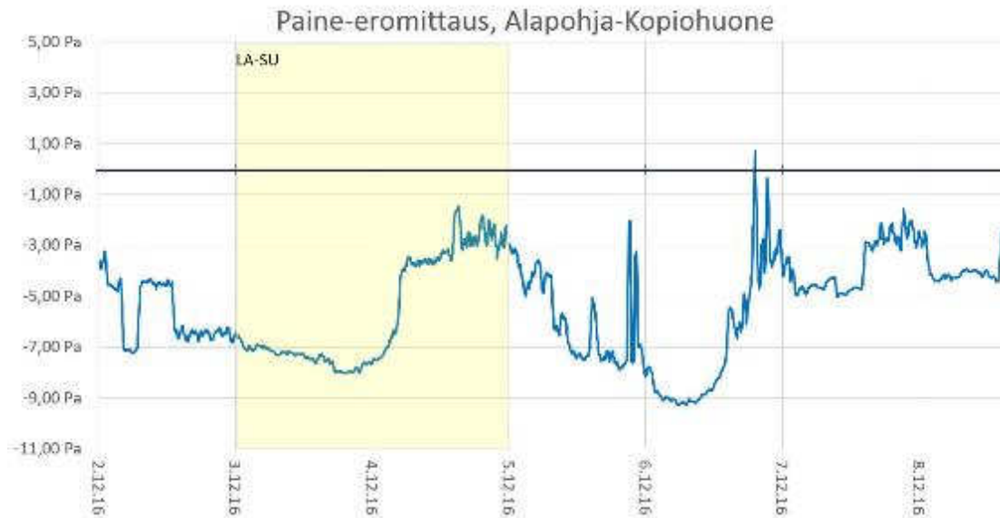
Kuva 153. Alapohjan ja kopiohuoneen välinen paine-eromittaus 2. 12. – 8. 12. 2016 välisenä aikana.
