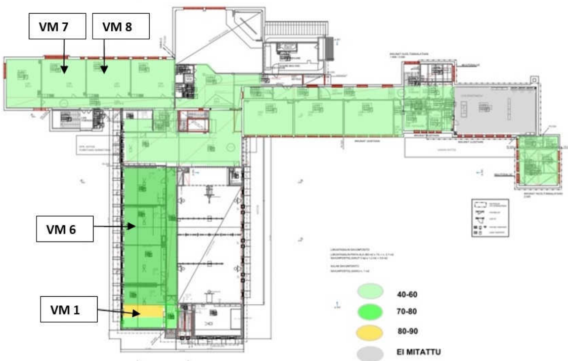
Kuva 136. Toisen kerroksen pintakosteuskartoitus ja viilto- ja porareikämittauskohdat.
