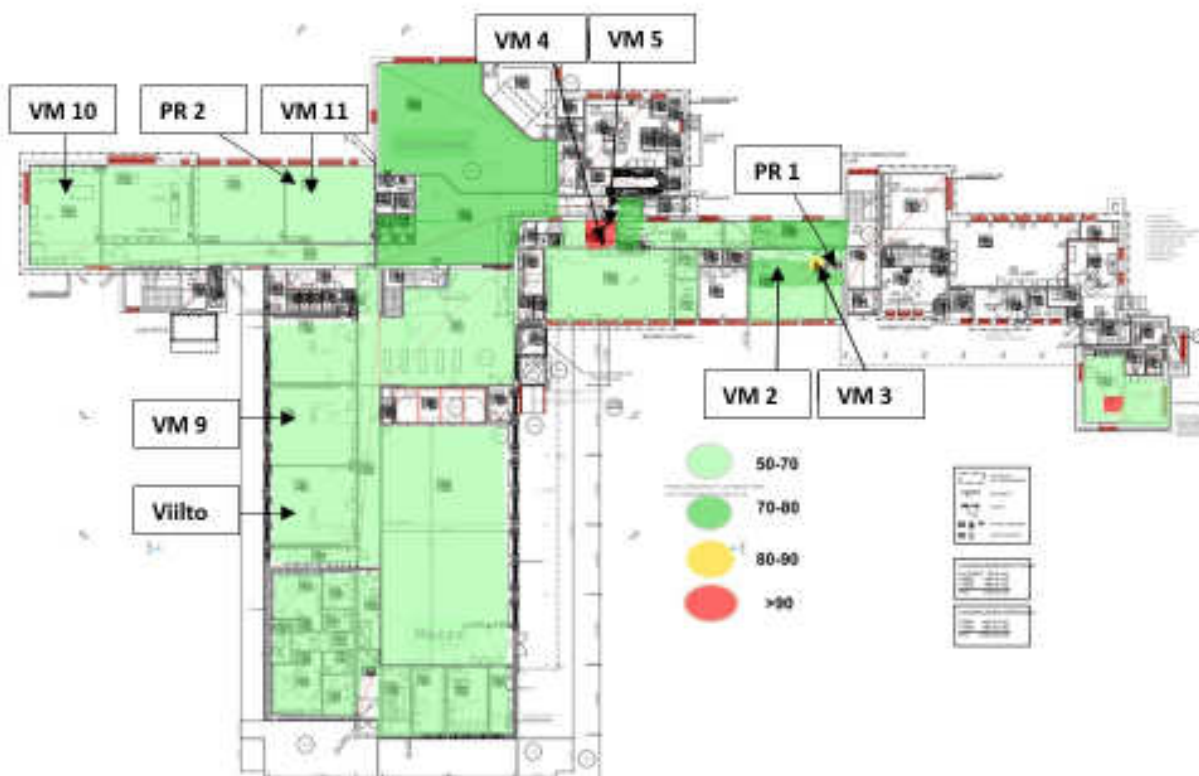
Kuva 135. Ensimmäisen kerroksen pintakosteusastot sekä viilto- ja porareikämittauskohdat.
