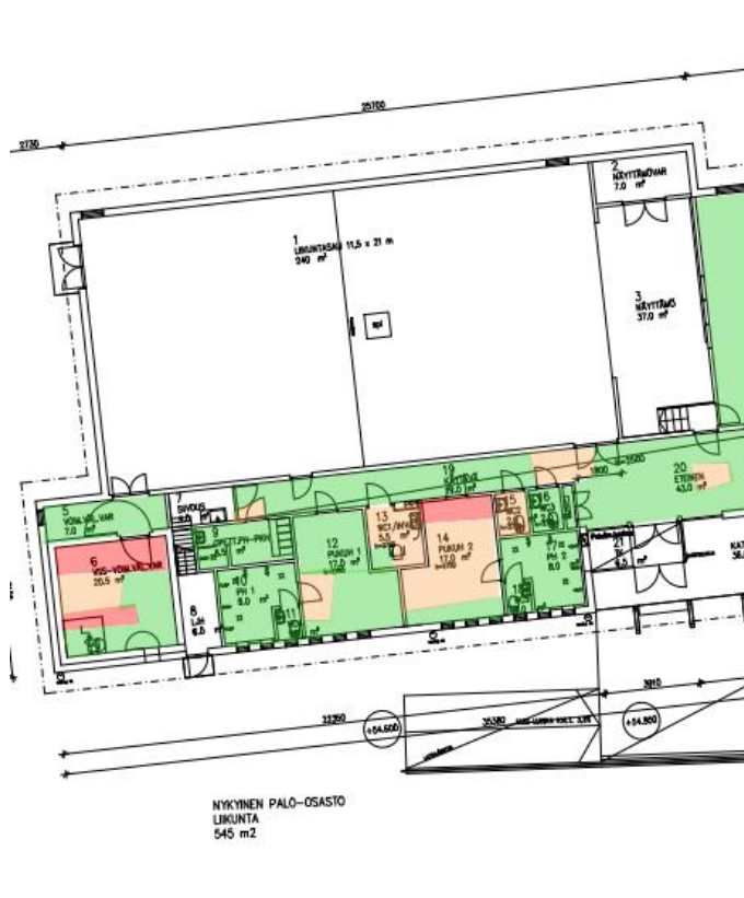
Kuva 3. Pintakosteudet liikuntasalin käytävä, varasto, pukukopit, suihkutilat.
