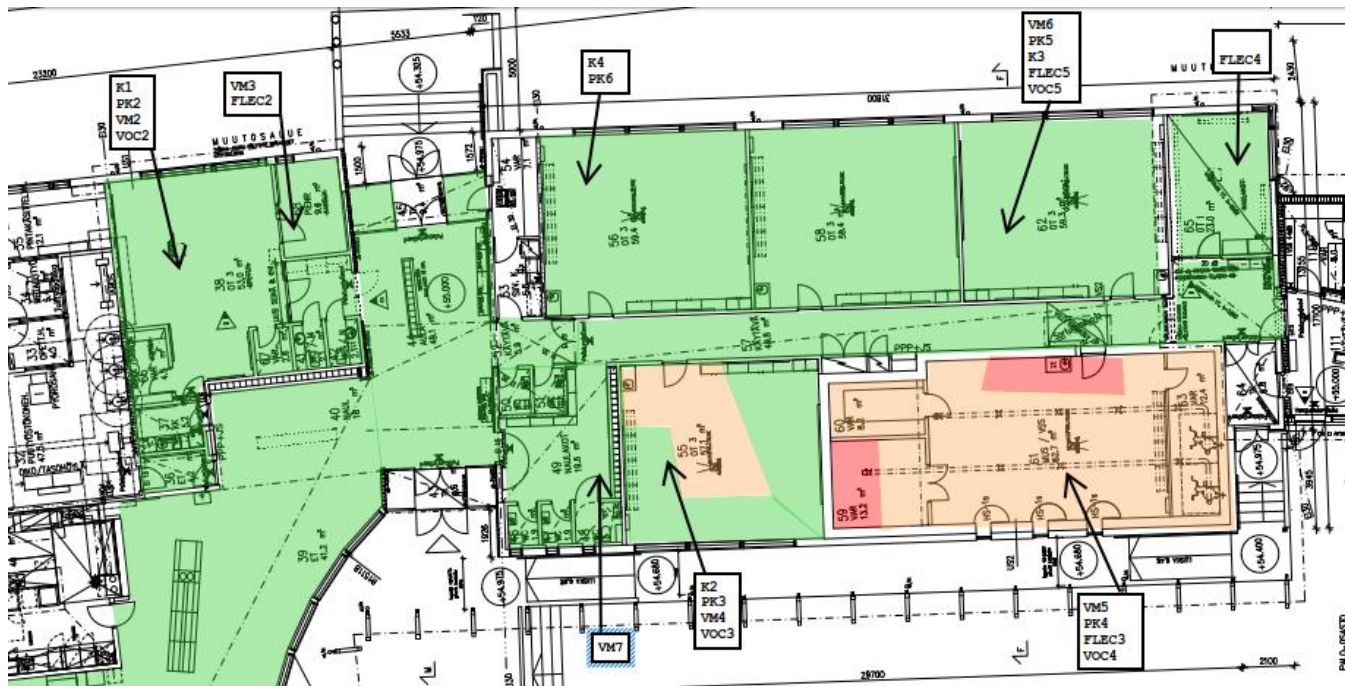
Kuva 1. Pintakosteudet ja näytteenottoapaikat eteläsiipi
