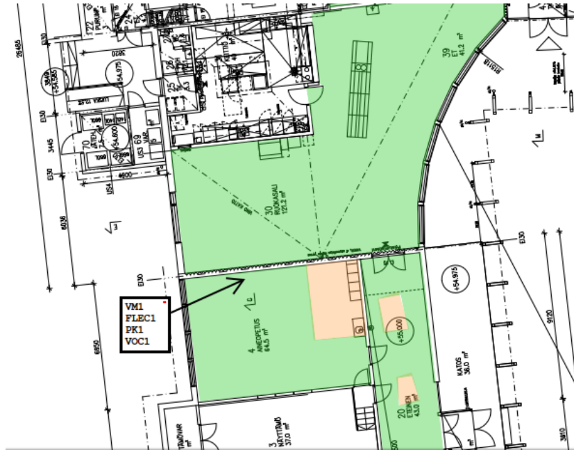
Kuva 2. Pintakosteudet ja näyttöpaikat ruokasali ja luokka 4.
