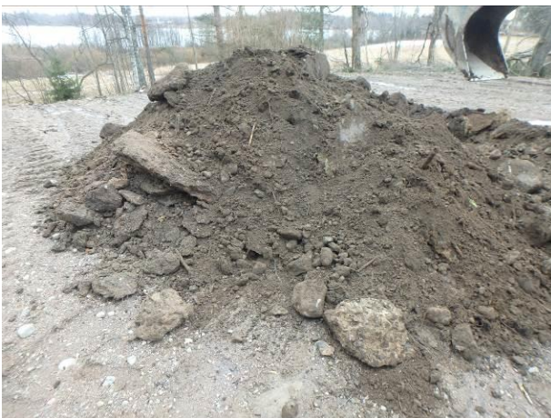
Valokuva 5. Koekuopan VAH6 maa-aineksia. Maassa yksittäisiä paloja jätejakeita, kuten puuta, muovia, betonia ja asfalttia.
